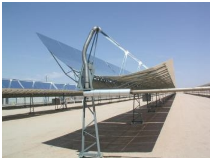
Figura 6 - Coletor Solar Parabólico Tipo Calha LS-2
